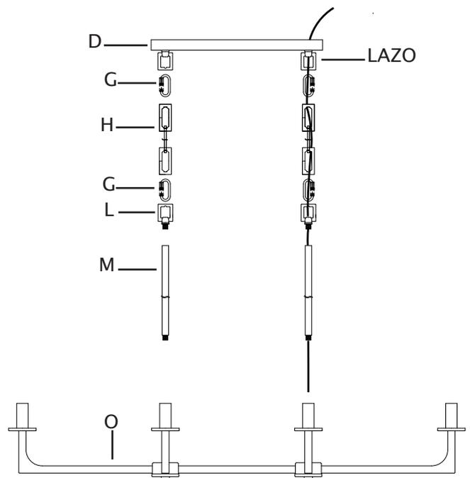
10. Deslice el último eslabón de la cadena al final de cada cadena (H) en el eslabón de bloqueo (G) en cada lazo (L) en la parte superior de cada vástago (M).
